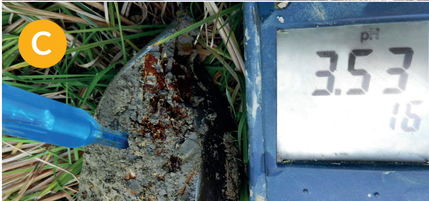
Bild A visar en potentiellt sur surfaltjord med svart/mörkgrå färg. Den kallas ibland också svartmocka, och har inte exponerats för syre. Bild B visar en sur sulfatjord med karaktäristiska rostfällningar och vertikala sprickor. Bild C visar en pH-mätning av sur sulfatjord. Foto: Gustav Sohlenius och Nelly Aroka/SGU.
